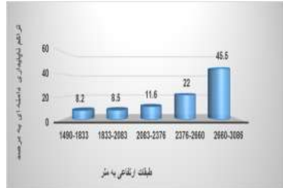
شکل ۱۲: نمودار درصد تراکم ناپایداری دامنه‌ای در کلاس‌های طبقات ارتفاعی Figure 12: Density percent plot of slope instability for elevation classes
