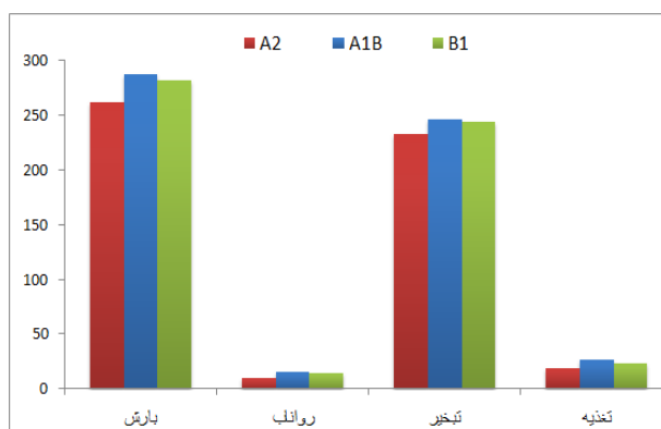
شکل ۴: مقادیر میانگین سالانه بارش، رواناب، تغذیه آب زیرزمینی و تبخیر و تعرق تحت سناریوهای A2، B1 و A1B برای دوره (۲۰۳۰-۲۰۱۳) در حوضه آبریز تسوج
