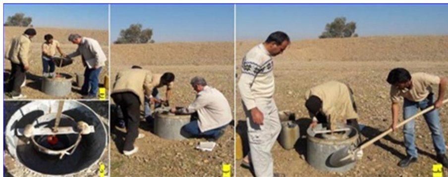
شکل ۲: نمونه استوانه مضاعف اندازه گیری نفوذپذیری
