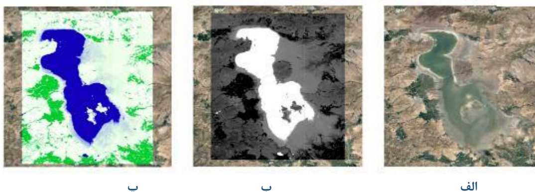
شکل ۵: برآورد پهنه‌های آبی دریاچه ارومیه توسط تصاویر میانگین‌گیری شده از ماه‌های سه سال اخیر. الف) جدیدترین تصویر ماهواره‌ای از دریاچه ارومیه، ب) خروجی شاخص آبی، پ) خروجی کلاس‌بندی شده جهت متمایز کردن پهنه آبی
