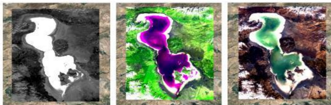
شکل ۸: برآورد پهنه‌های آبی دریاچه ارومیه از میانگین ماه‌های دو سال اخیر توسط سنجنده لندست ۹. الف)؛ تصویر RGB از دریاچه ارومیه، ب)؛ نقشه با رنگ کاذب R-NIR-B، پ)؛ شاخص NDWI
