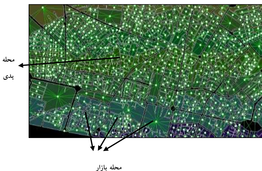
شکل ۱۰: نقشه میزان تراکم اتصالات و دیدهای متوالی با مخروط‌های بصری که تعداد یال‌ها در هر مخروط نشانگر تعداد دید و دسترسی‌ها از یک مکان به سایر مکان‌ها پیرامون خود است این نقشه مربوط به بخش مرکزی و بافت فرسوده است.
