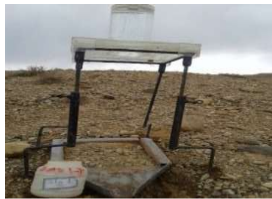
شکل ۲: دستگاه شبیه‌ساز باران در واحدهای کاری غیر مارنی (راست) و مارنی (چپ)
