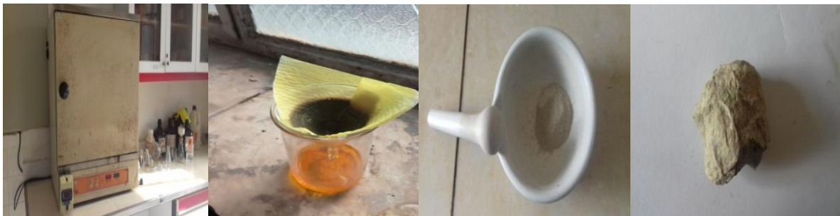
اشکال ۹، ۱۰، ۱۱ و ۱۲: به ترتیب از سمت راست نمونه سنگ مورد آزمایش، سنگ پودر شده، پودر مخلوط با اسید کلریدریک رقیق و دستگاه آون جهت خشک کردن نمونه رسوب پودر شده در آزمایشگاه رسوب‌شناسی
