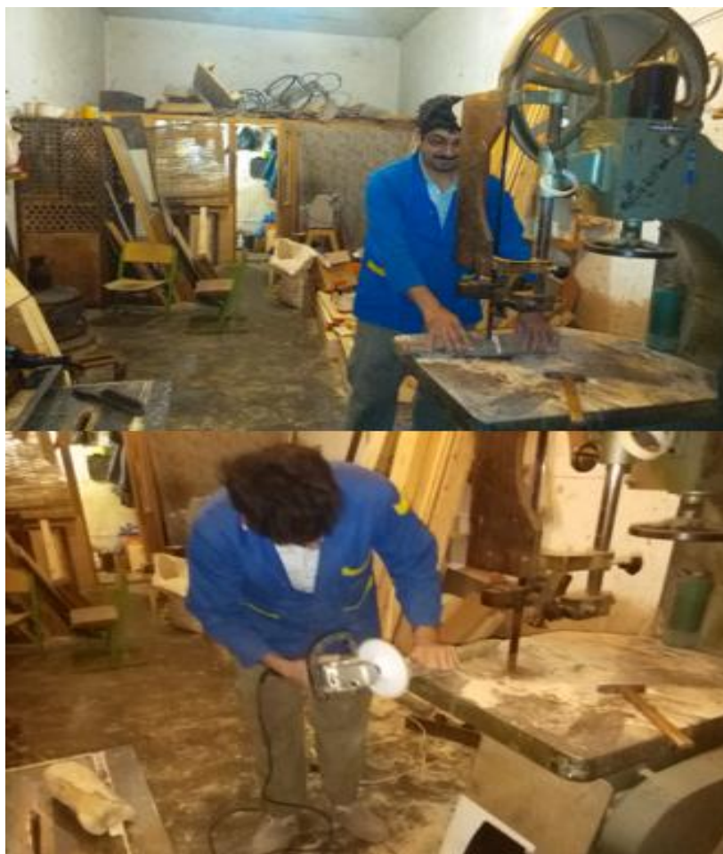
شکل ۳: تهیه مقطع نمونه‌ها و صیقل دادن با سمباده برقی
