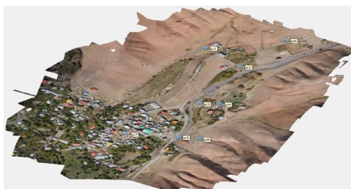
شکل ۶: ارتوفتوموزائیک ایجاد شده از منطقه با استفاده از ابر نقاط به وجود آمده
