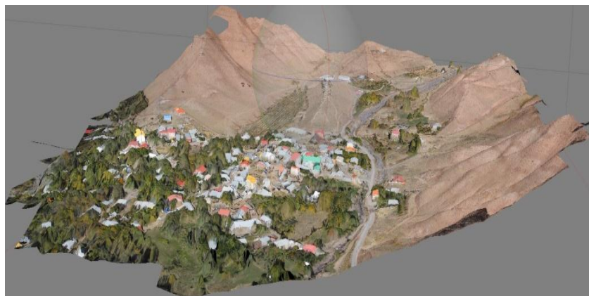
شکل ۴: ابر نقاط ایجاد شده از منطقه مورد مطالعه با اعمال رنگ طبیعی به آن Figure 4: Cloud points created from the study area by applying natural color to it
