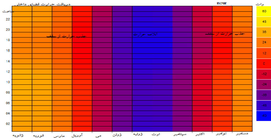
شکل ۱۵: جذب و اتلاف حرارتی سقف ساختمان در محدوده پژوهش
