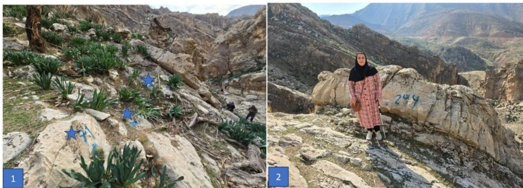
شکل ۴. روش و فواصل نمونه‌برداری سیستماتیک در برش مورد مطالعه؛ (۱) فواصل نمونه‌برداری و (۲) شماره‌گذاری نمونه‌ها بر پایه متر از مبدأ برش.
